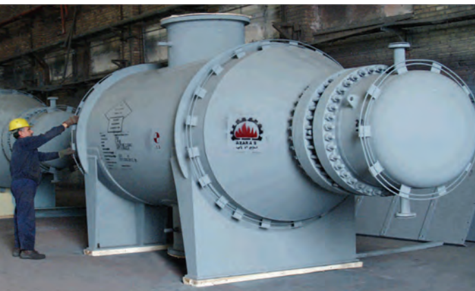
▲ مبدل‌های حرارتی پروژه NGL (SLKL)
